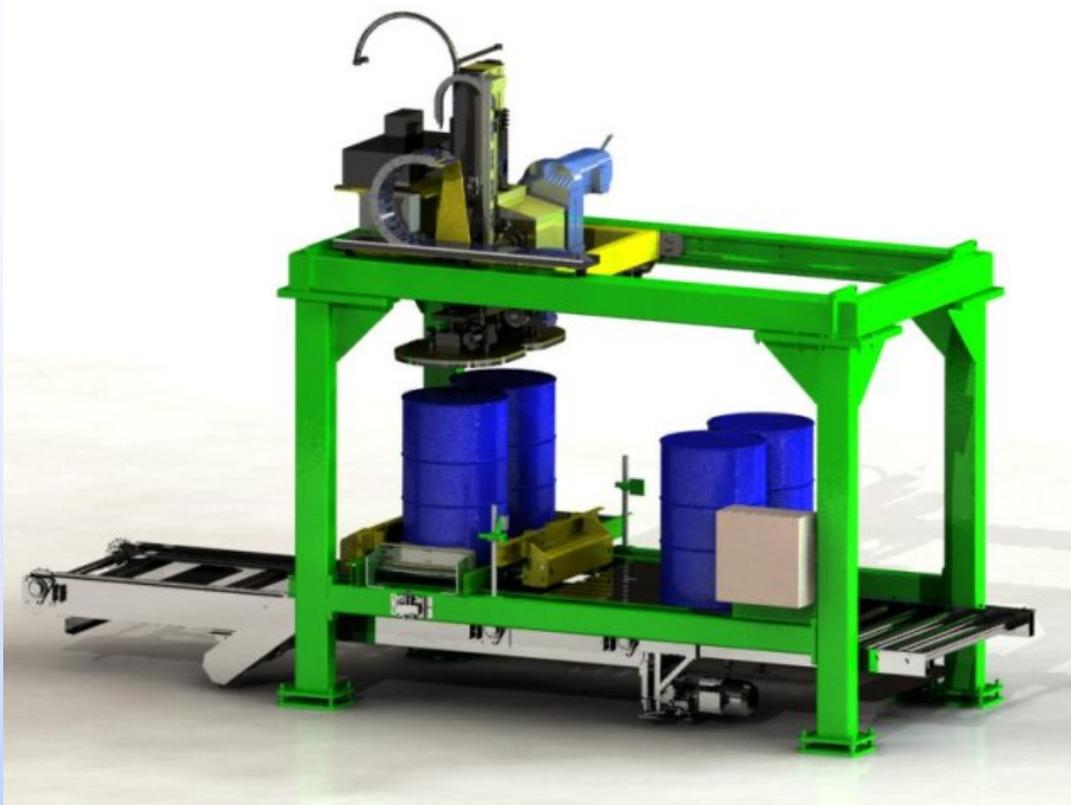
Fasspalettieranlage Vakuumsauger 2 Achsen
