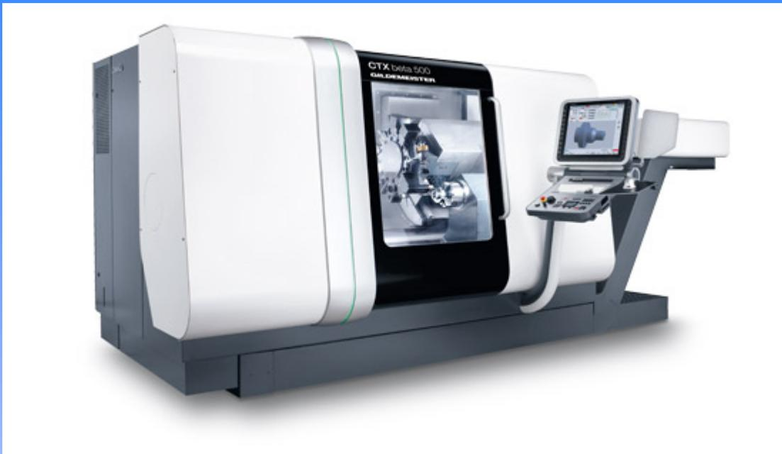
CTX Beta 500 mit angetriebenen Werkzeugen und zusätzlicher y- Achse
