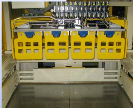
Ballenpalettierer mit hydraulischer Greifereinheit und zusätzlicher
